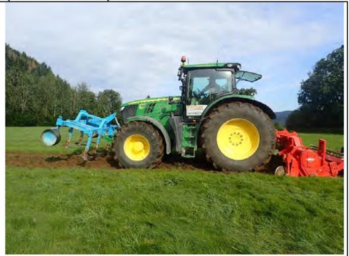
Anlage der Frässtreifen GPS-Gesteuert
